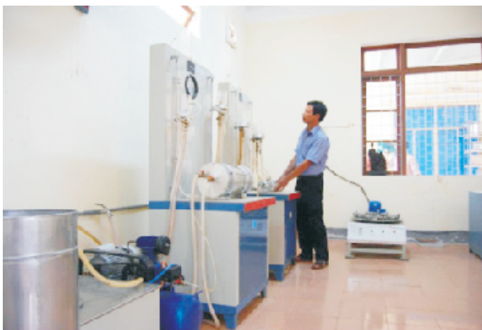
Cán bộ Trung tâm Kỹ thuật Đo lường Thử nghiệm xác định độ thấm xuyên vải địa kỹ thuật sử dụng trong xây dựng công trình
