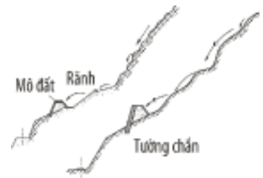
Hình 3: Con chạch (mô đất), rãnh và tường hứng đỡ trên sườn dốc
