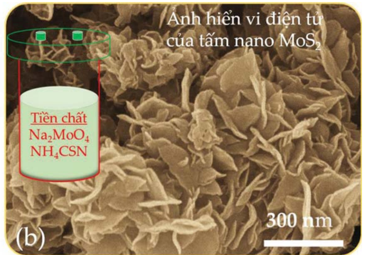
Các dạng cấu trúc pha khác nhau của MoS 2 (a), và ảnh hiển vi điện tử bề mặt của tấm nano MoS 2 với một vài đơn lớp (b)
