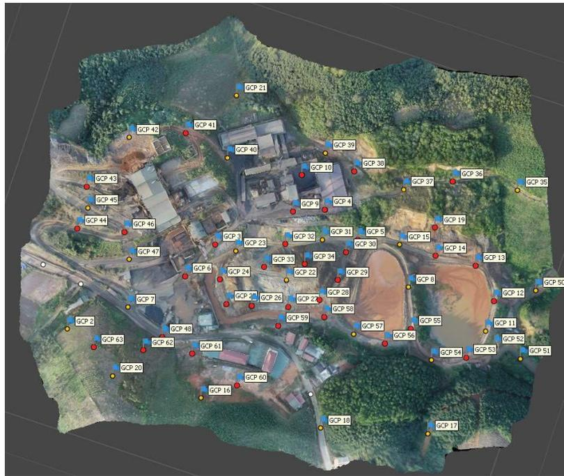
**Hình 7: Sơ đồ các điểm khống chế ảnh (màu vàng) và điểm kiểm tra (màu đỏ)**
