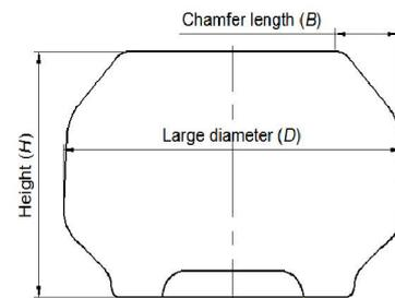
Fig. 3. Design parameters for 2<sup>nd</sup> preform
