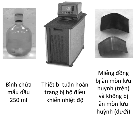
Hình 4. Các dụng cụ và thiết bị phục vụ phân tích ăn mòn lưu huỳnh theo ASTM D1275B
