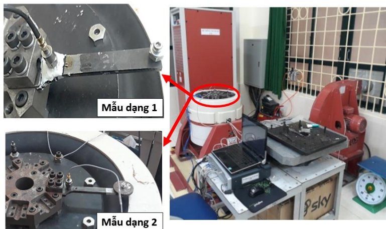
Hình 6. Thí nghiệm môi trên hệ thống LDS V830-335.
