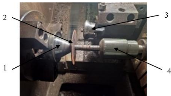
Hình 6. Gá kẹp sơ đồ miết trên máy tiện CNC
