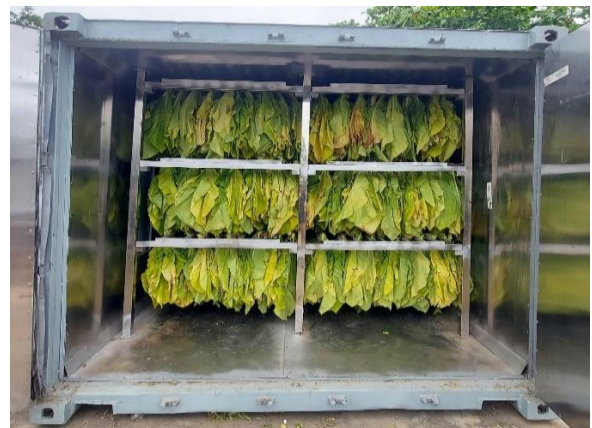
Hình 2.5. Bố trí vật liệu sấy trong buồng sấy
