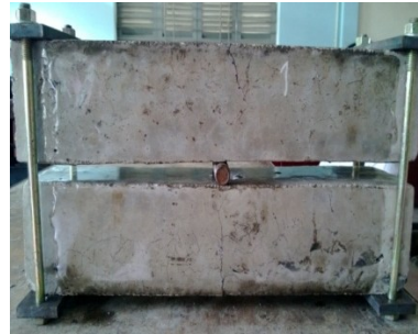
Hình 1. Vết nứt được tạo bởi thí nghiệm uốn 3 điểm (Gowripalan và cộng sự., 2000)
