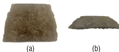
Hình 2. Hình ảnh sản phẩm ván ép từ thân cây Ngô sau quá trình ép nóng (a) Mặt trên của tấm ván; (b) Mặt nghiêng thể hiện độ dày và cấu trúc
