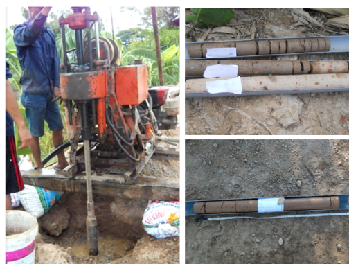
Hình 6. Thiết bị khoan lõi lấy mẫu hiện trường
