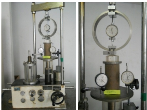
Hình 7. Thí nghiệm UCS mẫu soilcrete
