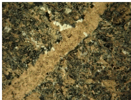
Hình 6. Diabaz thạch anh. Mạch thạch anh-carbonate cắt qua diabaz. Các vi tinh plagiocla bị biến đổi carbonate hóa mạnh. Lm DP5a. 2Ni^+ 10^{\circ} \times 5^{\circ}
