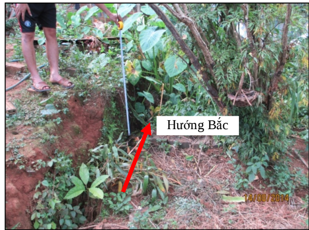
Hình 7. Vết nứt sụp trong căn nhà số 135/33/7A, rộng 30cm, sụp sâu 60cm
