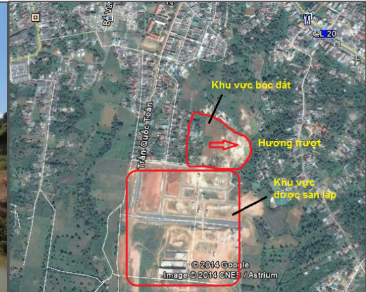
Hình 10. Khu vực trượt lở bị bóc đất
