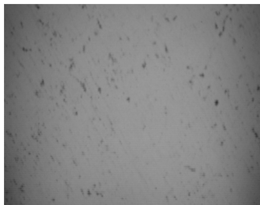
Hình 6 . Mẫu M3-X20 tạp chất (màu đậm) của mẫu tinh luyện bằng hạt lọc.
