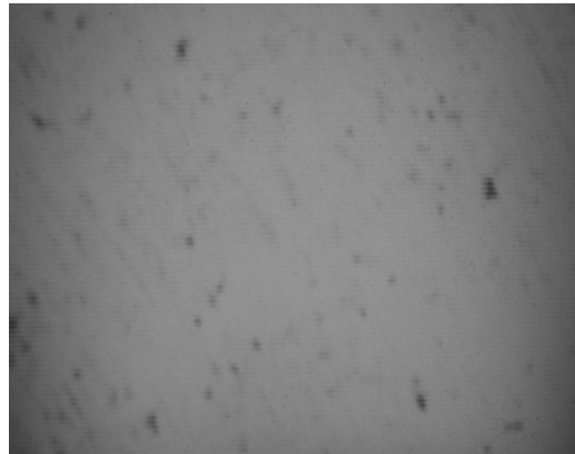
Hình 5. Mẫu M2-X20 tạp chất (màu đậm) của mẫu tinh luyện bằng siêu âm.
