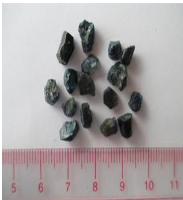
Hình 11. Corindon trước khi xử lý: sắc cạnh
