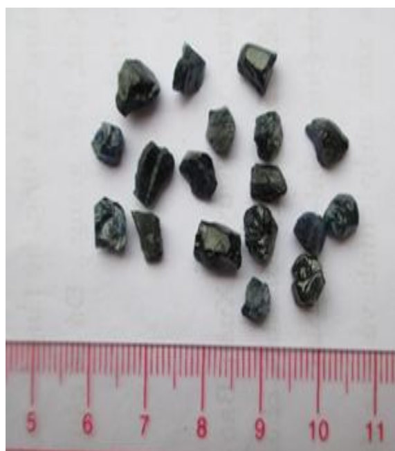
Hình 12. Corindon sau khi xử lý: bề mặt bị đốt chảy
