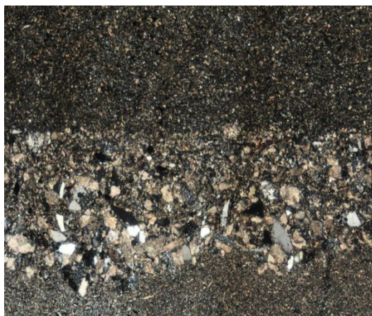
Hình 8. Hình chụp lát mỏng cho thấy phân lớp mỏng xen kẽ sét/bột/vôi sét, 2 nicol, 2,5X. Mẫu 2
